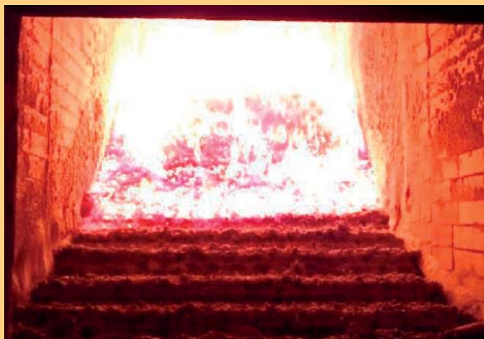
Sfruttamento ottimale della griglia senza formazione di ponti sopra al letto di brace (ardens GmbH, 2017).
