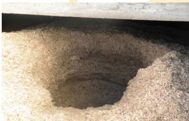
Formazione di pozzi con estrazione a doppio braccio a molle (fonte: Jenni, 2015)
